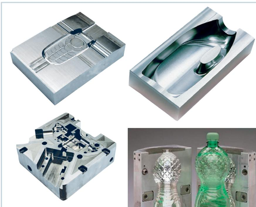
**Gleichwertig:** Die Bilder zeigen Beispiele von HSC-gefrästen Teilen. Man kann davon ausgehen, dass sowohl das HSC-Fräsen als auch die Senkerosion in Bezug auf die Bauteilgenauigkeit (Formfehler in der Größenordnung 2 bis 5  $\mu$ m) weitgehend gleichwertig sind.
