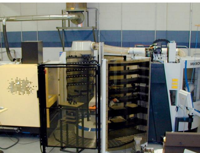
**Partnerschaft:** Alternativ kann eine Kombination beider Fertigungsverfahren, wie in dieser automatisierten Fertigungszelle, sinnvoll sein. Dabei werden per Senkerosion (hier Agie) diejenigen Partien bearbeitet, die durch HSC-Fräsen (hier Mikron) nicht bearbeitbar sind.
